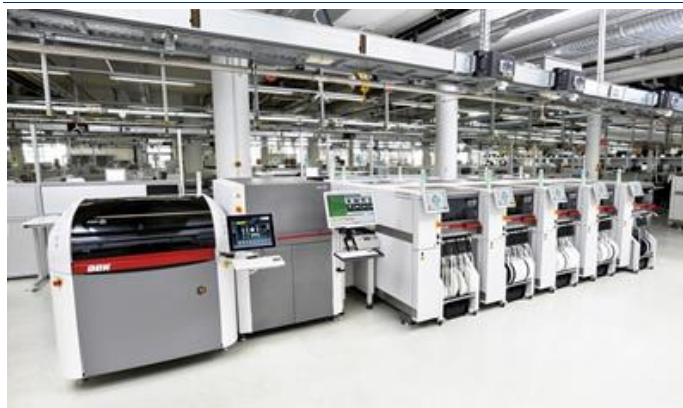
图 15：ASM Pacific 处理 SLP 的 SMT 设备：SIPLACE TX 贴装模块
