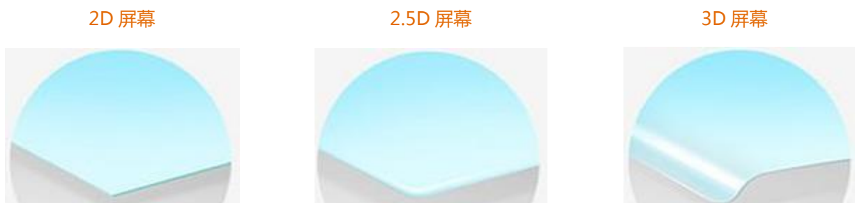
图 10 2D 屏幕、2.5D 屏幕及 3D 屏幕比较
