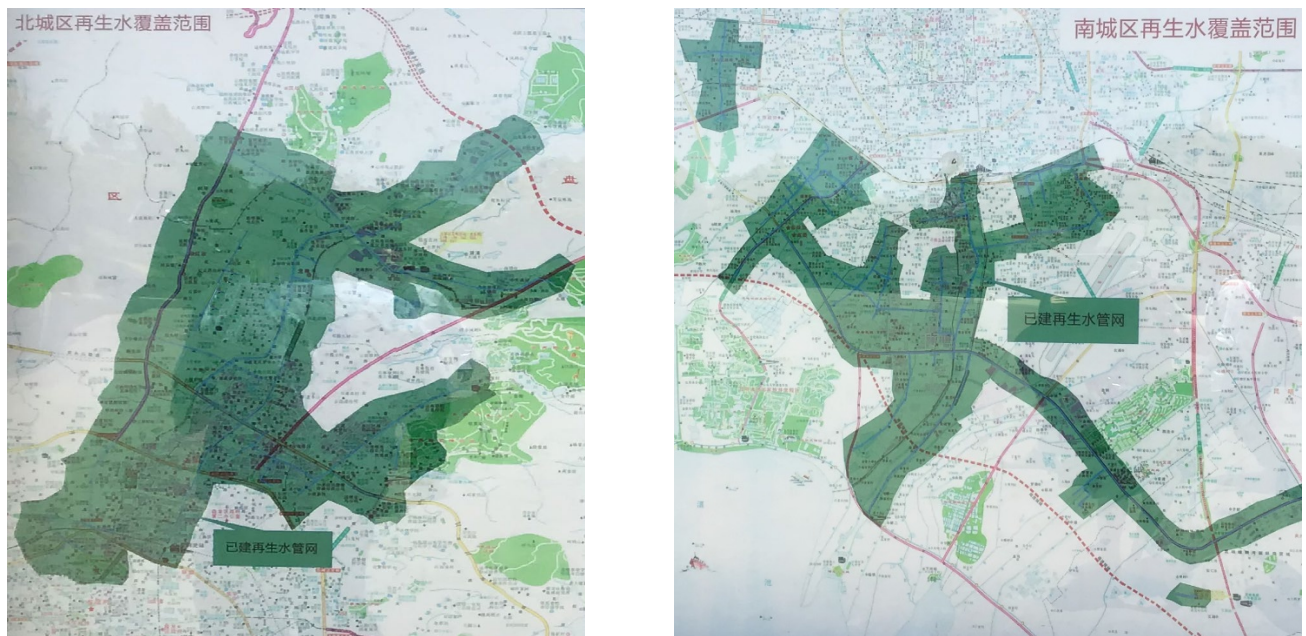
图 60：昆明市再生水管网总体布置图
